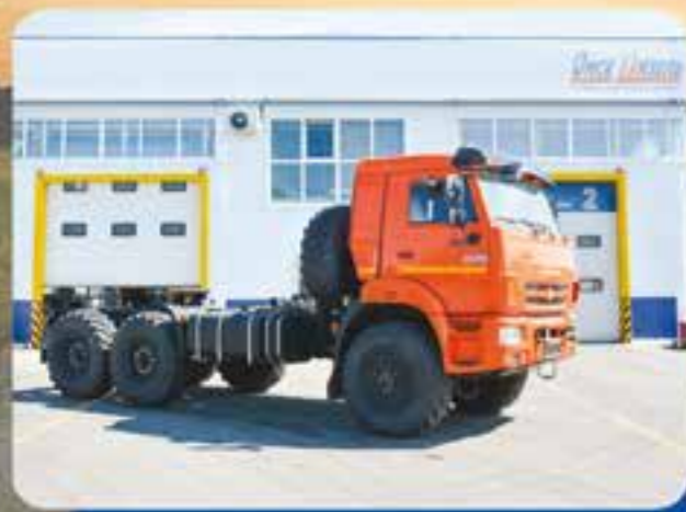
Тягач-вездеход для перевозки различных видов грузов, высота ССУ 1530 мм
