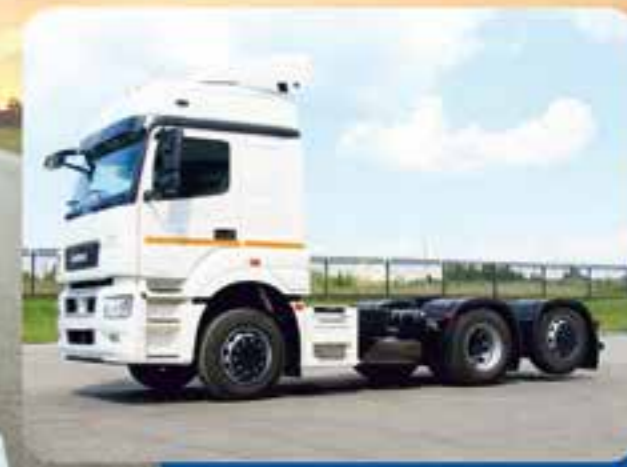
Тягач для перевозки различных грузов, высота ССУ 1150 мм
