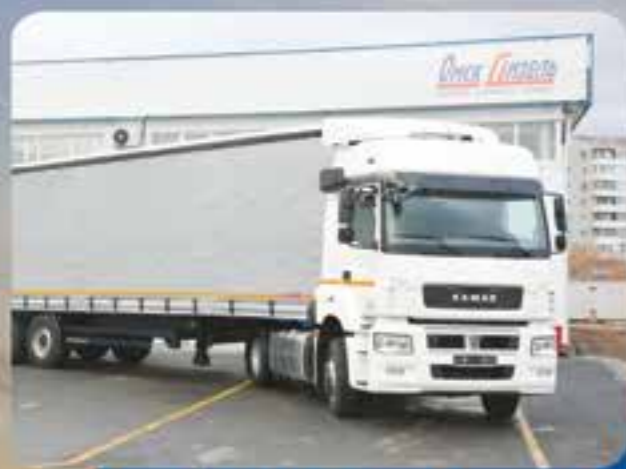
Тягач для перевозки различных видов грузов, высота ССУ 1150 мм
