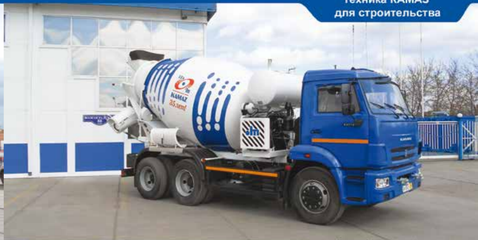
Автомобиль для перевозки раствора бетона
