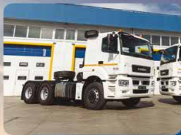
Тягач для перевозки различных видов грузов, высота ССУ 1300 мм
