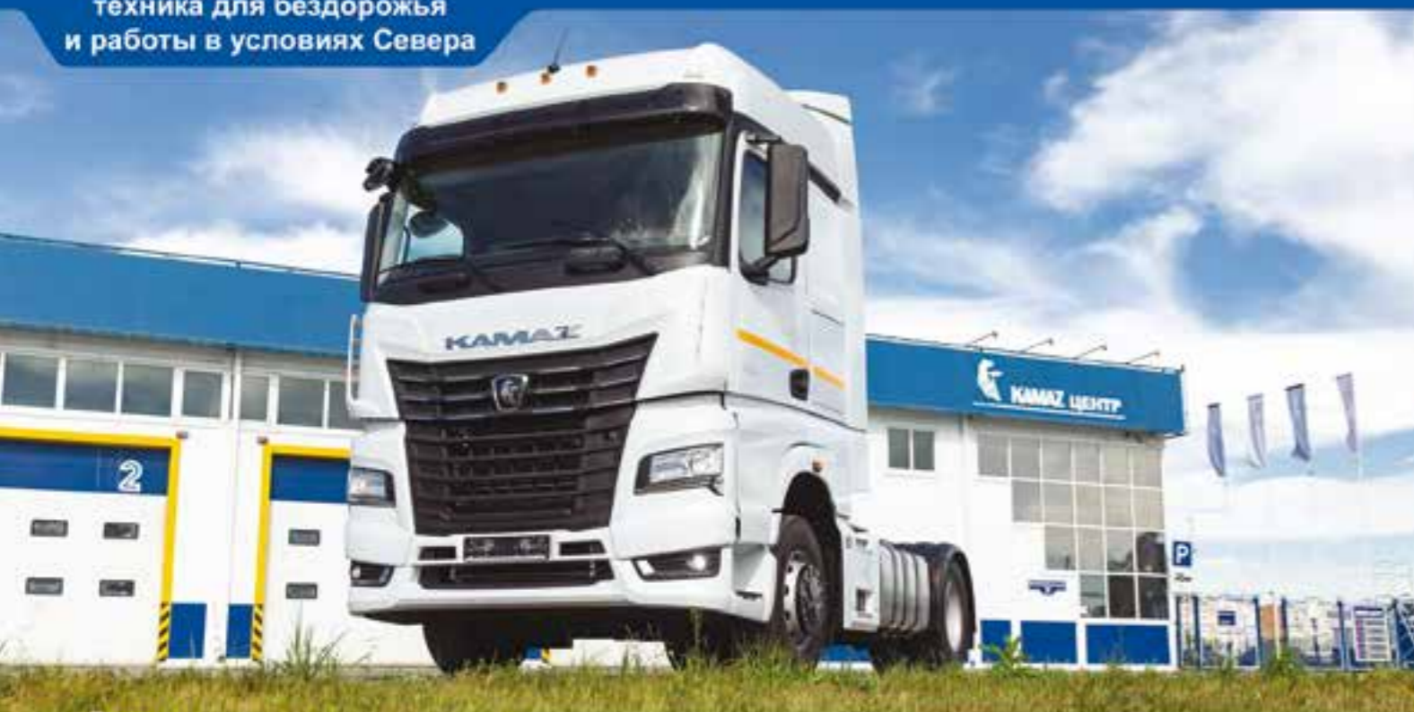
Тягач для перевозки различных видов грузов, высота ССУ 1150 мм
